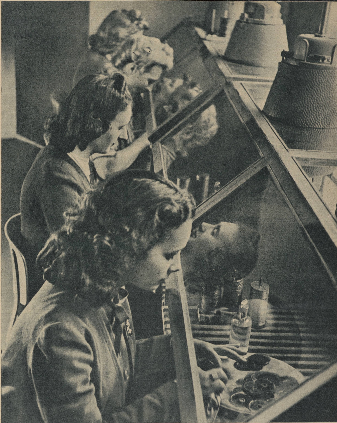
ARBEID FOR DYKTIGE HENDER. Disse unge franske kvinner er i en berliner-fabrikk beskjeftiget med å bearbeide tynne metallplater i glassskap som er fylt med syredamper. Ventilatorer suger bort dampene, glass-skiver beskytter arbeiderne mot faren ved å ånde inn gassene. En smule vitenskapelig gjennomtenkt organisasjon på den ene siden, omhu på den annen, og alt klaffer fortreffelig
