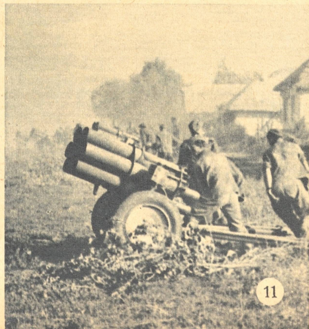
Kanoner uten mannskap? De seks granater i hver kaster blir fyrt av ved elektrisk tenning av betjeningsmannskapet, som er gått i dekning ca 20 meter bak kanonene. Den nye drivmåten til dette våpens prosjektill gjør at batteriene hylles inn i røyk og støv PK-fotos: Krigskorrespondent Walz
