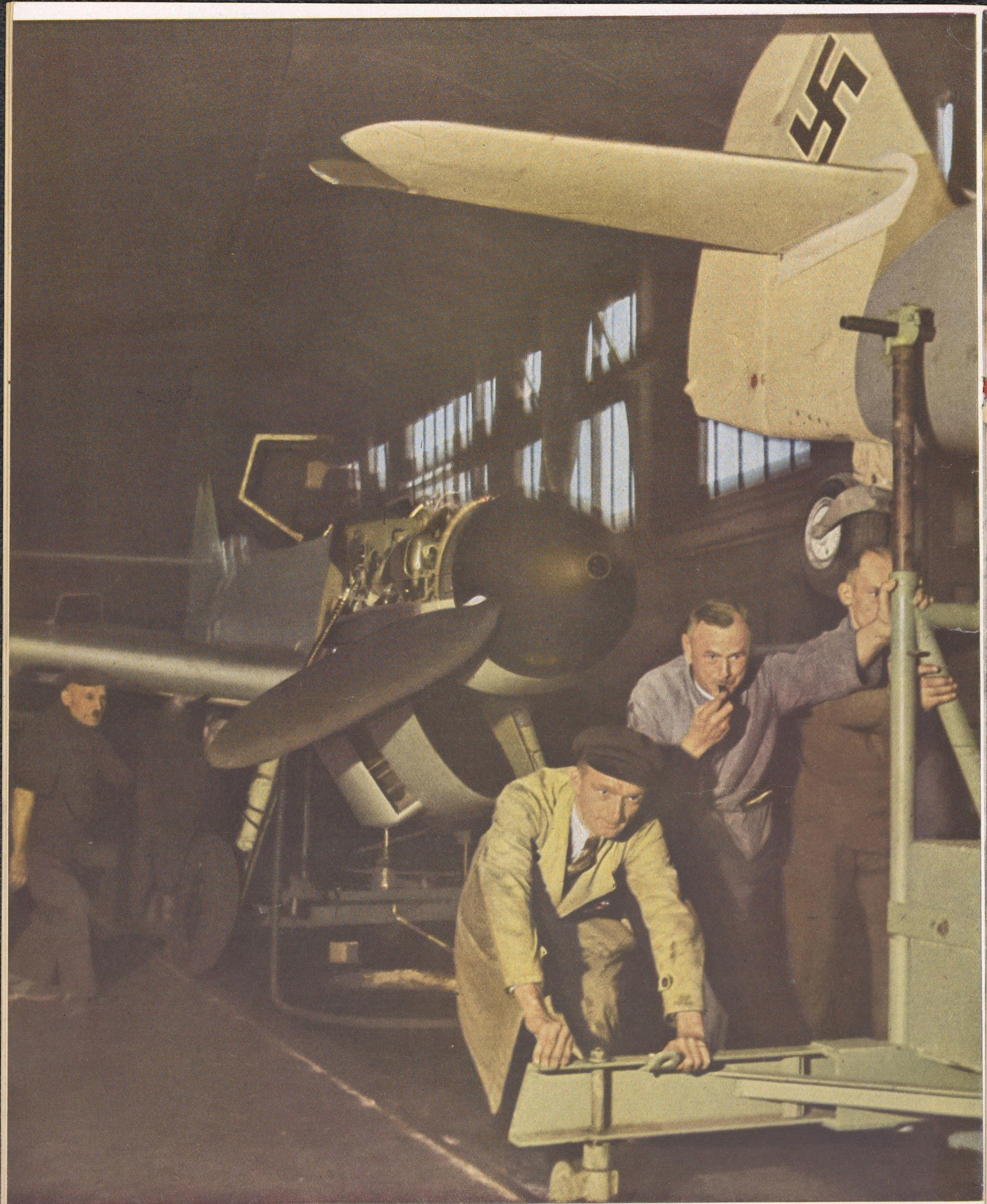
Ein Pfiff: alle Fäuste packen zu, um in der Fertigmontagehalle die lange Kette der Jagdflugzeuge, die mit rot-weißen Stangen untereinander starr verbunden sind, zehn Schritte weiter auf den nächsten Arbeitsplatz zu schieben, wobei das vorderste Flugzeug „ausgestoßen“ wird. Es verläßt, fertig zum Tanken und zum Probeflug, seine Geburtsstätte. PK-Aufnahme: Kriegsberichtler Hubmann
